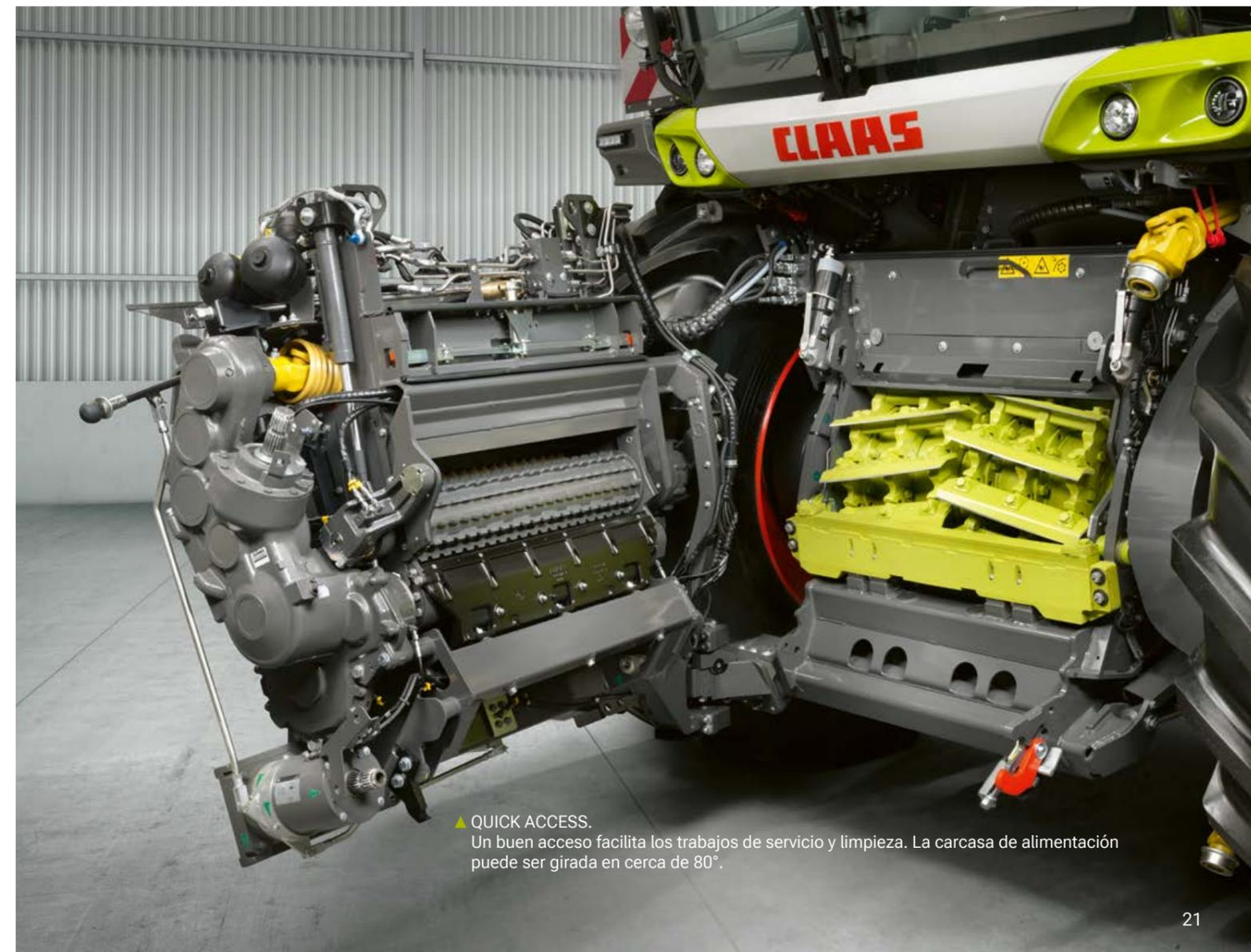
▲ QUICK ACCESS. Un buen acceso facilita los trabajos de servicio y limpieza. La carcasa de alimentación puede ser girada en cerca de 80°.
