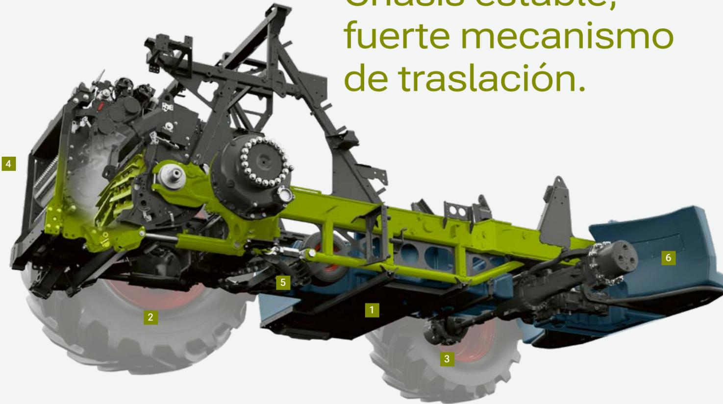
1. Robusto chasis con construcción inferior que absorbe las cargas
