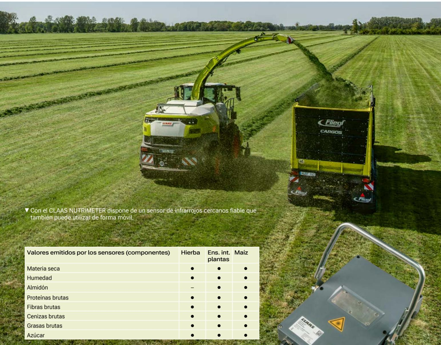
▼ Con el CLAAS NUTRIMETER dispone de un sensor de infrarrojos cercanos fiable que también puede utilizar de forma móvil.
