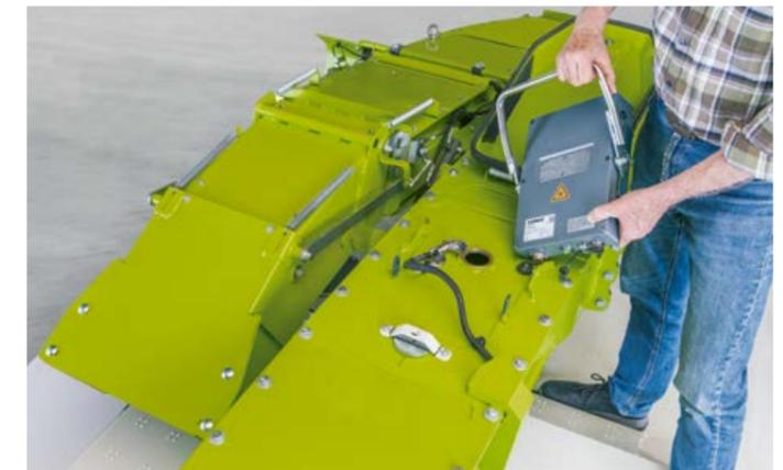
▲ El sensor de infrarrojos cercano, CLAAS NUTRIMETER, analiza su material picado a tiempo real y adapta – dependiendo del contenido de masa seca – automáticamente la longitud de corte y la dosificación de aditivos de ensilado. Componentes importantes son medidos para determinar la calidad del material de cosecha, mostrados como valores en CEMIS y editados a través de CLAAS connect.
