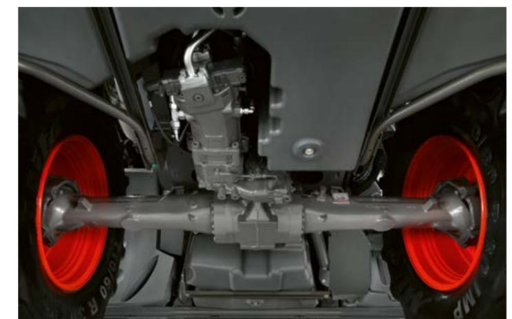
► El robusto eje directriz o eje directriz motriz detrás está preparado para una gran carga de hasta 10 t. Permite ser adaptado al ancho de vía con dos distanciadores de diferente ancho. Los sensores del ángulo de dirección se encuentran protegidos en el cuerpo del eje.
