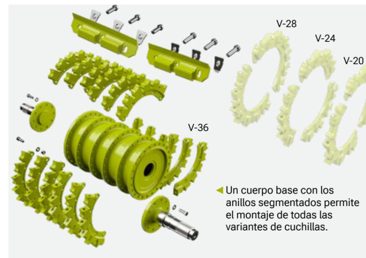
◀ Un cuerpo base con los anillos segmentados permite el montaje de todas las variantes de cuchillas.
