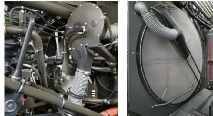
◀ La gran criba rotativa del tamiz del radiador es aspirada continuamente. El cepillo interior de la criba permite ser activado.
