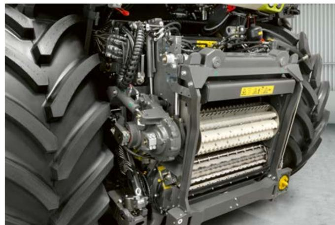
▲ La compactación previa totalmente hidráulica permite un gran caudal de procesamiento en todos los materiales de cosecha y longitudes de corte y se encarga de una calidad del material picado siempre homogénea. [Página 20](#)
