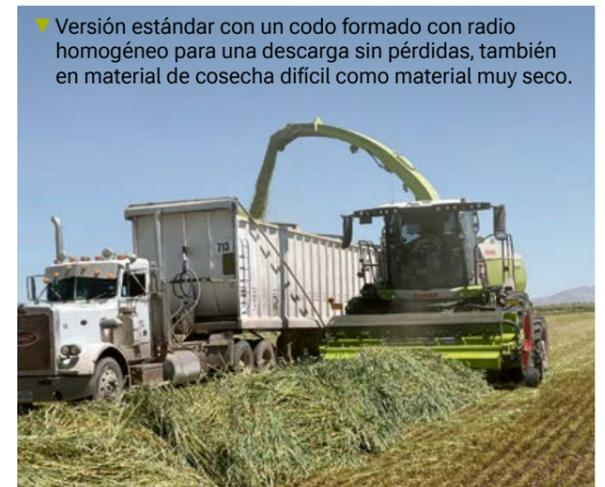
▼ Versión estándar con un codo formado con radio homogéneo para una descarga sin pérdidas, también en material de cosecha difícil como material muy seco.
