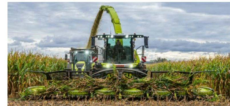
▼ AUTO CONTOUR y ruedas estabilizadoras suavemente activas llevan el cabezal de maíz con precisión por el suelo.
