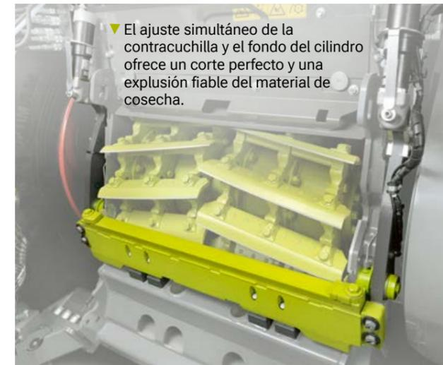
▼ El ajuste simultáneo de la contracuchilla y el fondo del cilindro ofrece un corte perfecto y una explosión fiable del material de cosecha.
