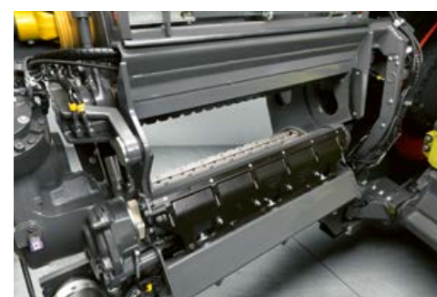
▲ De aandrukrollen kunnen voor onderhoudswerkzaamheden hydraulisch omhoog worden gezet.
