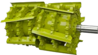
▲ Een derde van messen – alleen bij V-36 – voor heel lange haksellengte met symmetrische overdracht van oogstmateriaal.
