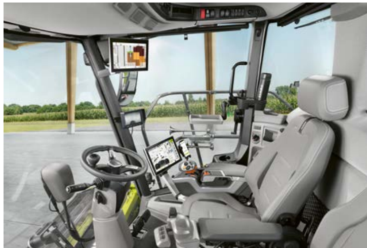
▲ Hoog comfort, een laag geluidsniveau en royaal rondomzicht. In de ruime, op silentbloccs gelagerde cabine blijft u ook op lange dagen ontspannen doorwerken. Pagina 38
