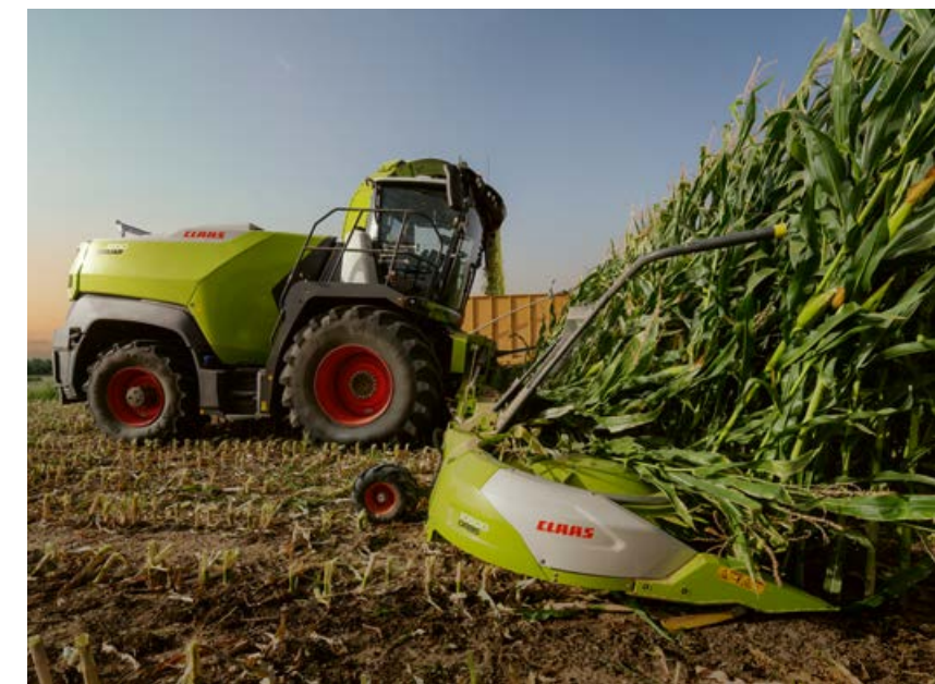
▼ Für lange Einsätze. - Kraftstofftank: 1.500 l gesamt - Harnstofftank: 145 l - Fährt mit Diesel und HVO
