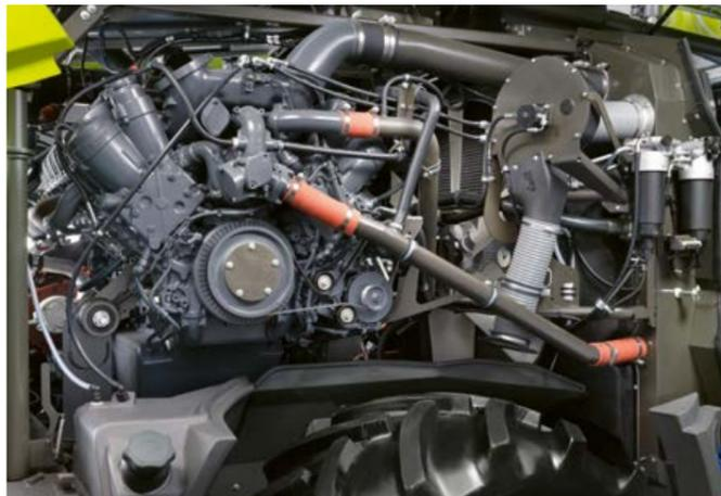
▲ Der quer aufgebaute Motor überträgt die enorme Leistung von bis zu 1.110 PS direkt und effizient. Die Leistung ist ideal auf den breiten Gutfluss und die Vorsatzgeräte abgestimmt. [Seite 34](#)
