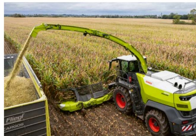
▲ Die breiteren Vorsatzgeräte wie das 14-reihige ORBIS 10500 setzen die installierte Motorleistung maximal in Durchsatzleistung um. Seite 14
