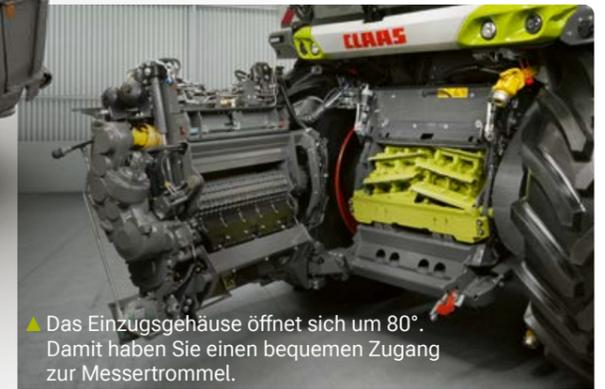
▲ Das Einzugsgehäuse öffnet sich um 80°. Damit haben Sie einen bequemen Zugang zur Messertrommel.
