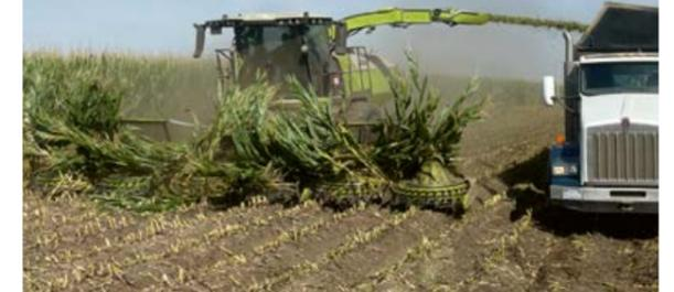
▼ Standardausführung mit gleichmäßig im Radius geformtem Krümmer, für verlustfreies Überladen, auch bei schwierigem Erntegut wie sehr trockenem Material.
