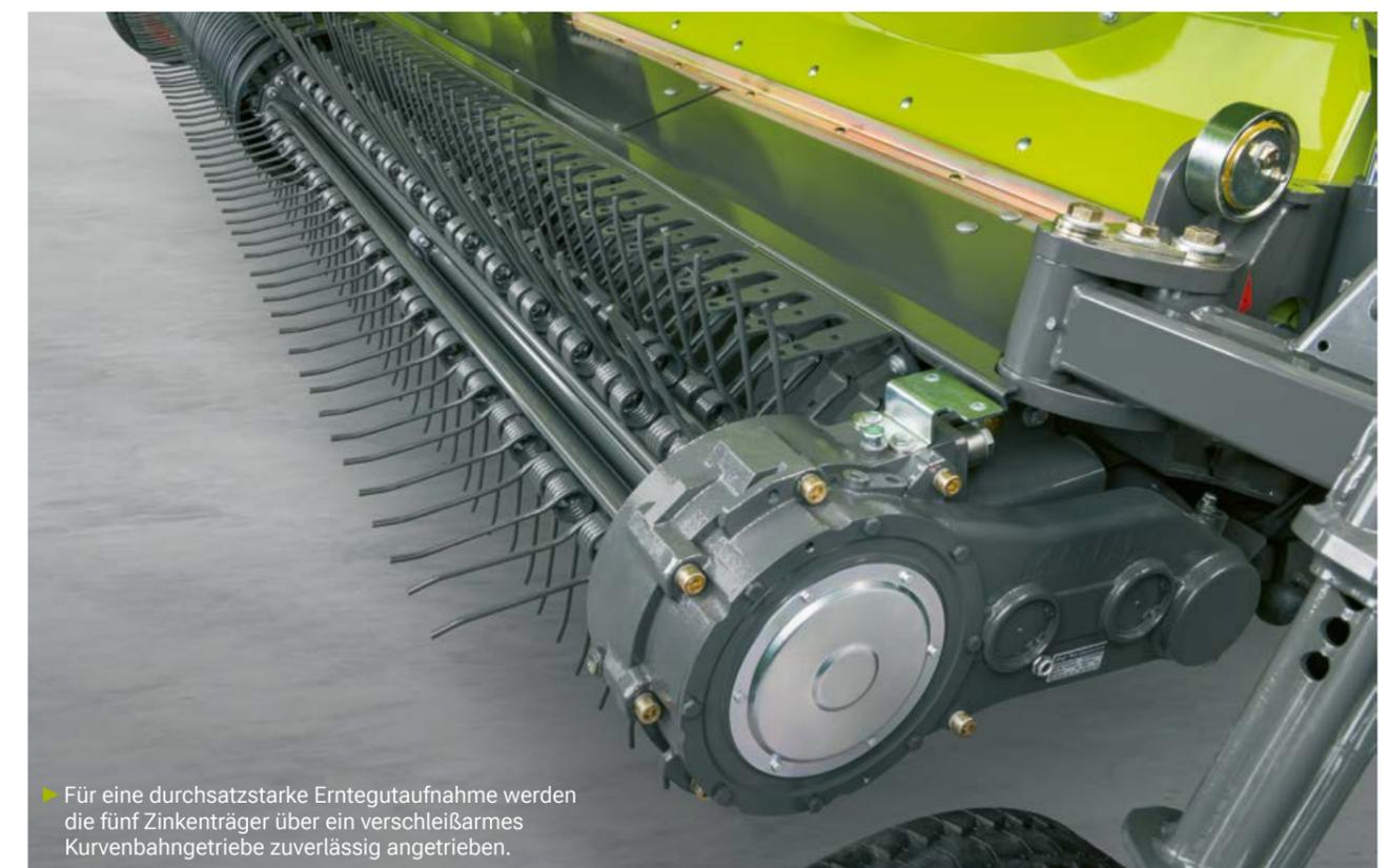
► Für eine durchsatzstarke Erntegutaufnahme werden die fünf Zinkenträger über ein verschleißarmes Kurvenbahngetriebe zuverlässig angetrieben.
