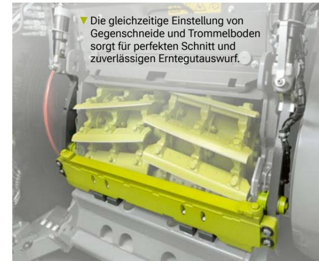
▼ Die gleichzeitige Einstellung von Gegenschnede und Trommelboden sorgt für perfekten Schnitt und zuverlässigen Erntegutauswurf.
