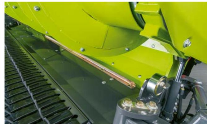
▼ Die hydraulische Schneckenvorspannung wirkt auf das Erntegut wie eine fünfte Vorpresswalze und optimiert dadurch Gutfluss und Durchsatz.
