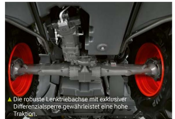
▲ Die robuste Lenktriebachse mit exklusiver Differenzialsperre gewährleistet eine hohe Traktion.
