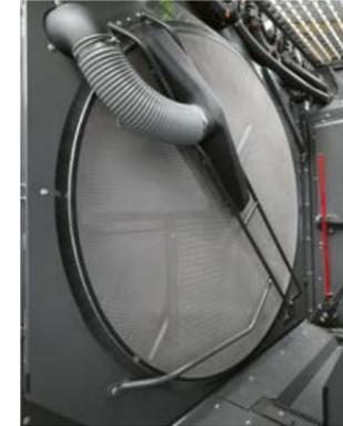
▼ Das große, rotierende Kühlerkorbsieb wird kontinuierlich abgesaugt. Die innenliegende Siebbürste ist zuschaltbar.
