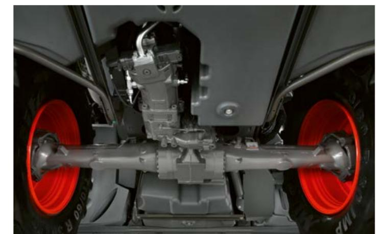
► Die robuste Lenk- bzw. Lenktriebachse hinten ist auf eine hohe Belastung von bis zu 10 t ausgelegt. Sie lässt sich mithilfe zwei unterschiedlich breiten Spacern in der Spurbreite anpassen. Die Lenkwinkelsensoren liegen geschützt im Achskörper.
