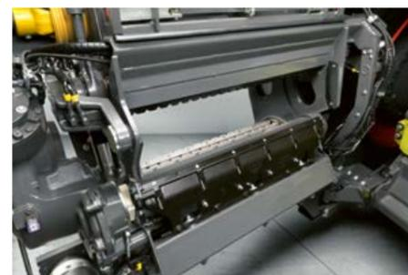
▲ Die Vorpresswalzen können Sie für Wartungsarbeiten hydraulisch aufahren.
