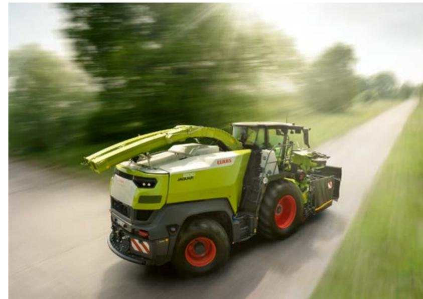
▲ Der Wechsel zwischen Arbeits- und Transportmodus gelingt schnell und einfach per Knopfdruck. Der 2XL-Krümmer wird automatisch geschwenkt, zusammengeklappt und kompakt auf der Krümmerstütze abgelegt.
