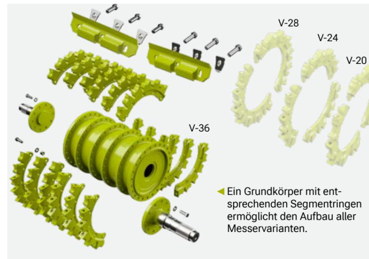
◀ Ein Grundkörper mit entsprechenden Segmentringen ermöglicht den Aufbau aller Messervarianten.
