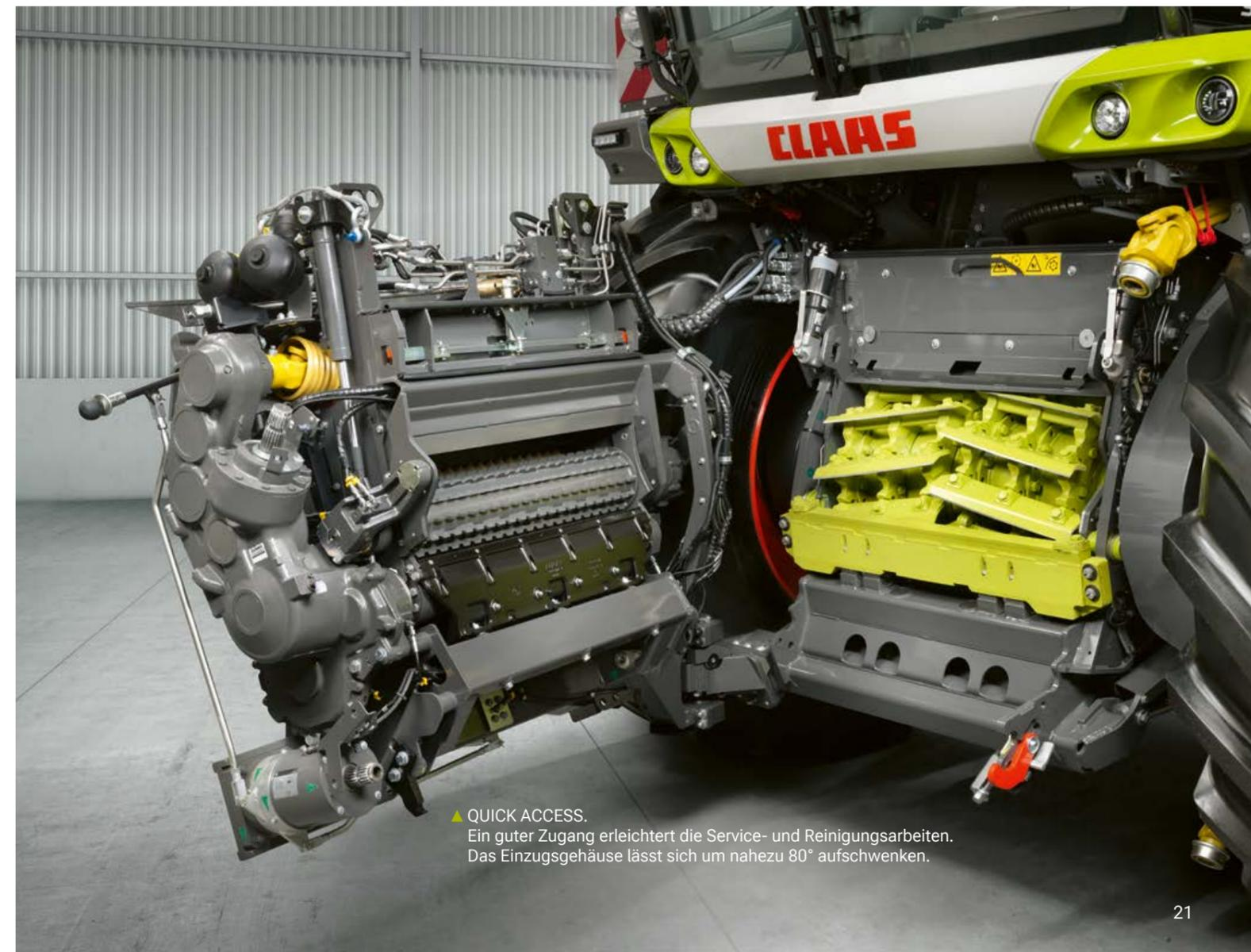
▲ QUICK ACCESS. Ein guter Zugang erleichtert die Service- und Reinigungsarbeiten. Das Einzugsgehäuse lässt sich um nahezu 80° aufschwenken.
