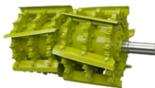
▲ Drittmesserbestückung (nur bei V-36) für sehr lange Schnittlängen mit symmetrischer Erntegutabgabe.
