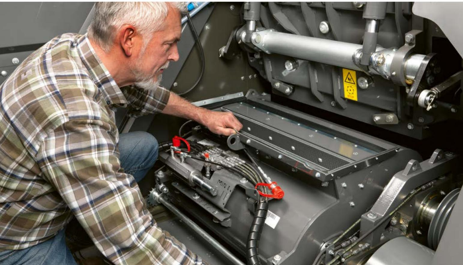
► Das Vorpressewalzengehäuse lässt sich dank QUICK ACCESS um ca. 80° aufschwenken, wodurch die breite Messertrommel mühelos zugänglich wird. Die Vorpressewalzen können Sie hydraulisch auffahren.
