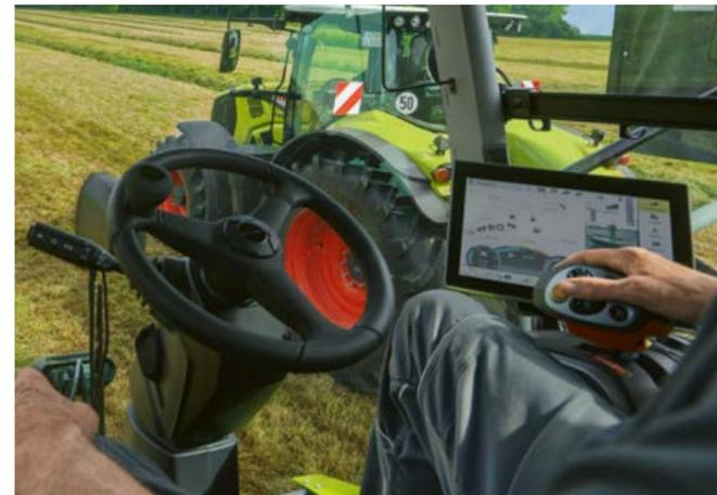
▲ CEMOS hält die eingestellte Drehzahl konstant und regelt Motorleistung und Geschwindigkeit entsprechend der Erntemasse. CEMOS AUTO CROP FLOW beugt Überlast vor. [Seite 42](#)
