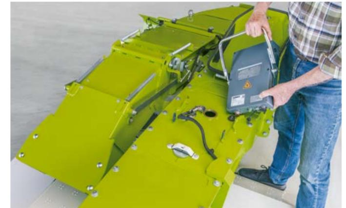
▲ Der Nahinfrarotsensor CLAAS NUTRIMETER analysiert Ihr Häckselgut in Echtzeit und passt – je nach Trockenmassegehalt – automatisch die Schnittlänge und die Siliermitteldosierung an. Wichtige Inhaltsstoffe werden für die Qualitätsbestimmung des Ernteguts erfasst, als Daten im CEMIS angezeigt und über CLAAS connect zugänglich gemacht.
