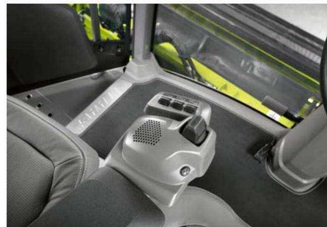
▲ Einfach und bequem manövrieren: Joystick-Lenkung und frei belegbare Funktionstasten befinden sich in der linken Armlehne. Seite 40
