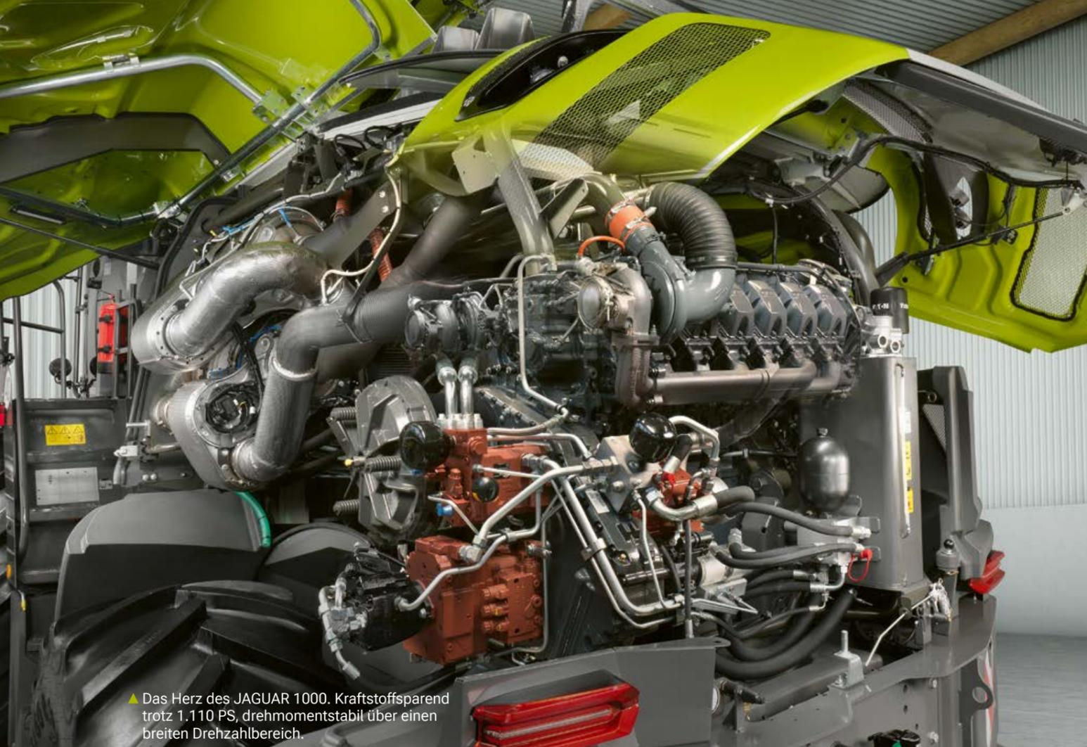
▲ Das Herz des JAGUAR 1000. Kraftstoffsparend trotz 1.110 PS, drehmomentstabil über einen breiten Drehzahlbereich
