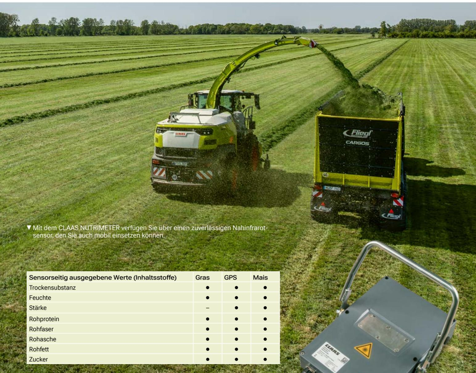
▼ Mit dem CLAAS NUTRIMETER verfügen Sie über einen zuverlässigen Nahinfrarotsensor, den Sie auch mobil einsetzen können.
