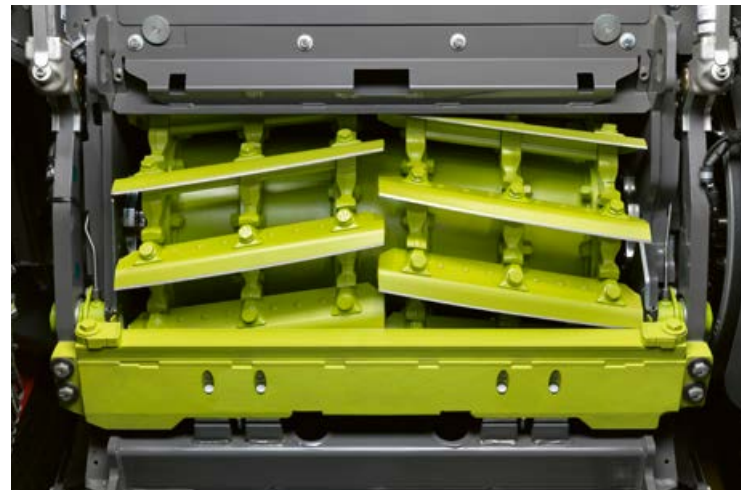
▲ Die 910 mm breite V-FLEX Messertrommel schneidet das Erntegut scharf und präzise. Die flexible Ausstattung erfüllt unterschiedlichste Anforderungen. Seite 22
