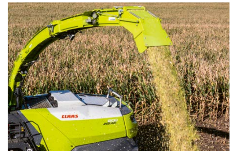
▲ Mit seinem großen Querschnitt ist der Auswurfkrümmer auf hohe und zuverlässige Durchsatzleistung ausgelegt. Seite 28
