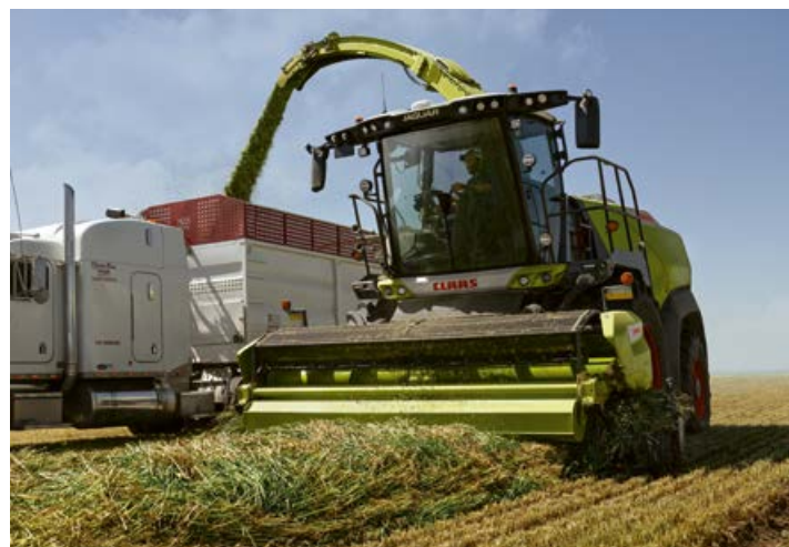
▲ Hochleistungsvorsatzgeräte wie die neue PICK UP mit bedingungsloser Zuführung ohne Überlastsicherung steigern Ihre Kampagnenleistung deutlich. Seite 16
