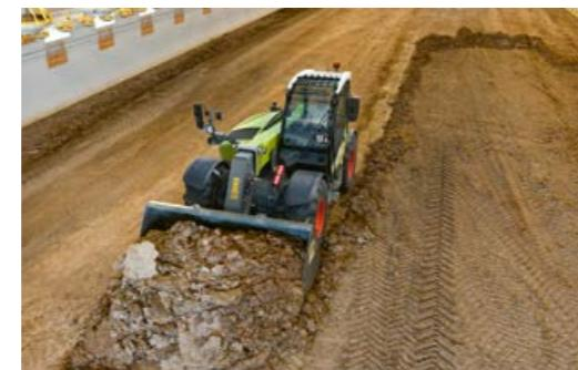
◀ Automatsko vraćanje lopate. Jednostavno spremite željeni položaj lopate i ponovno ga vratite upravljačkom palicom pritiskom na gumb.
