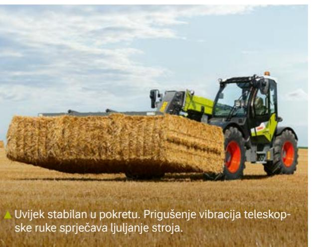
▲ Uvijek stabilan u pokretu. Prigušenje vibracija teleskopske ruke sprječava ljujanje stroja.
