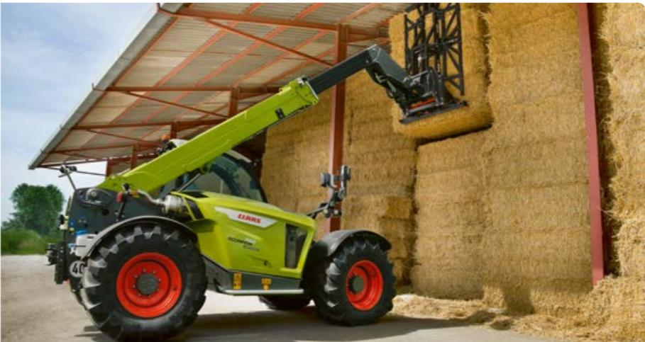
◀ Uz finu kontrolu radne hidraulike, možete precizno postaviti naslaganu robu čak i na velikim visinama i pažljivo raditi s opasnom robom ili teškim teretom. Sve što trebate učiniti je pritisnuti prekidač i brzina radne hidraulike automatski se smanjuje za pola.
