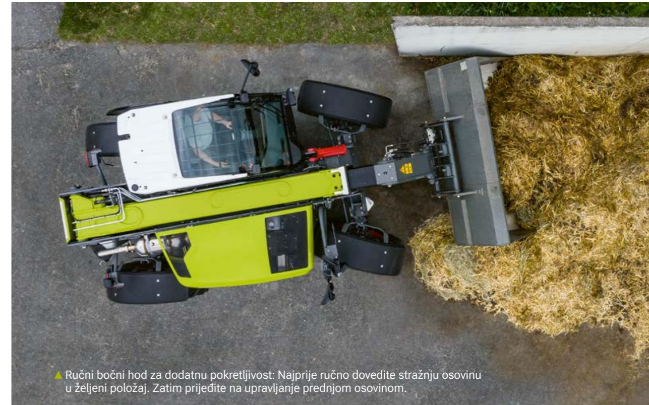
▲ Ručni bočni hod za dodatnu pokretljivost: Najprije ručno dovedite stražnju osovinu u željeni položaj. Zatim prijeđite na upravljanje prednjom osovinom.
