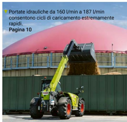
▼ Portate idrauliche da 160 l/min a 187 l/min consentono cicli di caricamento estremamente rapidi. Pagina 10
