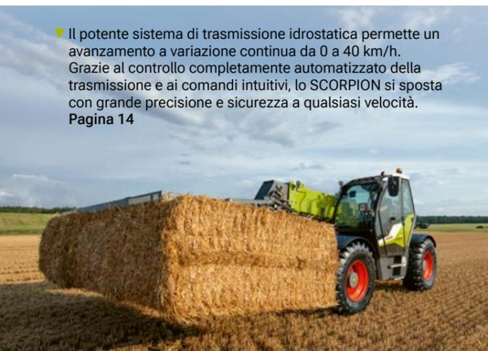
▼ Il potente sistema di trasmissione idrostatica permette un avanzamento a variazione continua da 0 a 40 km/h. Grazie al controllo completamente automatizzato della trasmissione e ai comandi intuitivi, lo SCORPION si sposta con grande precisione e sicurezza a qualsiasi velocità. Pagina 14
