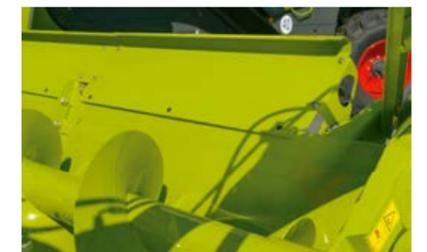
Réhausse d'auge supplémentaire pour éviter les pertes par projection dans le colza
