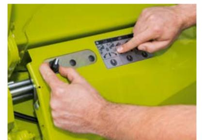
Commande de la position de stationnement et de nettoyage directement sur la barre de coupe
