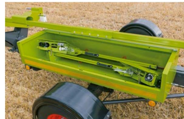
Afin de pouvoir transporter les scies à colza démontées en toute sécurité, tous les chariots de coupe sont dotés d'un coffre de transport verrouillable.
