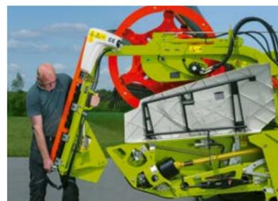
Un simple branchement suffit pour récolter du colza. Le montage des scies à colza à entraînement hydraulique s'effectue en quelques minutes, sans aucun outil. L'activation des vis d'alimentation est automatique et intervient dès que les scies à colza sont en place. La barre de coupe est prête pour la récolte.
