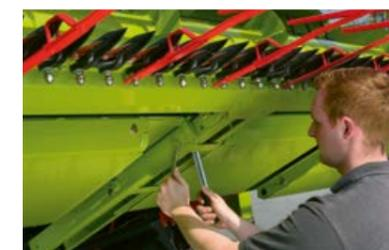
Vis de réglage de la longueur de tablier facilement accessibles
