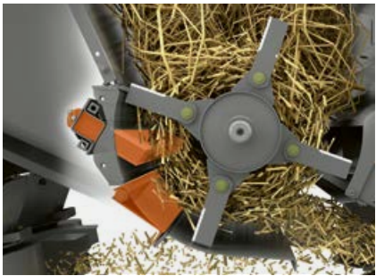
SPECIAL CUT专用切碎器中的定刀和可摆动的底板元件
