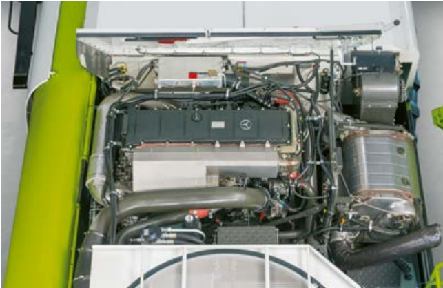
LEXION 8700配备460 kW / 626马力的Mercedes Benz OM 473
