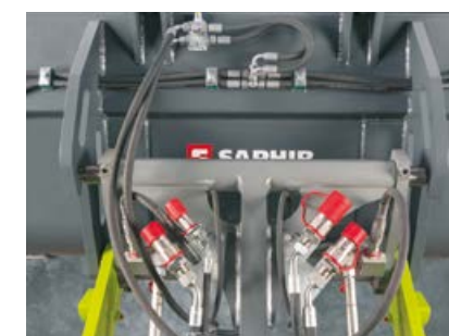
Na sprednjem delu breztladni povratek in dodatni vod za odkapno olje s priključkom na vpetju priključkov (644 / 537).
