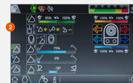
Omejitev višine dviga in globine spusta je prikazana na 9-palčnem zaslonu na dotik.
