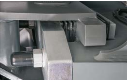
Gumijasti blažilniki v zglobni šasiji za udobnejše delo.
