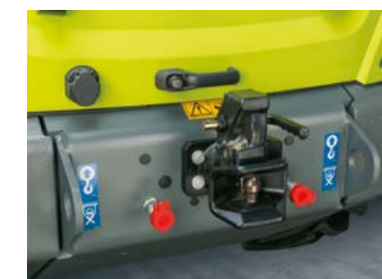
TORION 956 SINUS je opcijsko na voljo z breztlavnim povratnim vodom zadaj.
