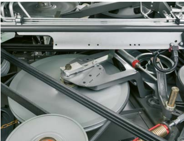
Enkelt att ställa in ingreppsdjupet för luckringsfingrarna.
