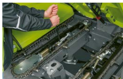
Łańcuchy przenośnika można łatwo naprężyć.
