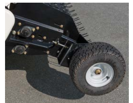
Głębokość roboczą kół kopiujących można ustawić.
