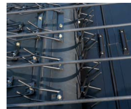
Palce szybko podbierają zebrany materiał i przekazują go płynnie dalej.
