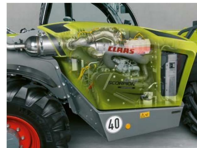
▲ Die Luft wird vorne im sauberen Bereich angesaugt und am Heck nach oben abgeführt. Das erschreckt die Tiere nicht und reduziert gleichzeitig die Staubentwicklung.
