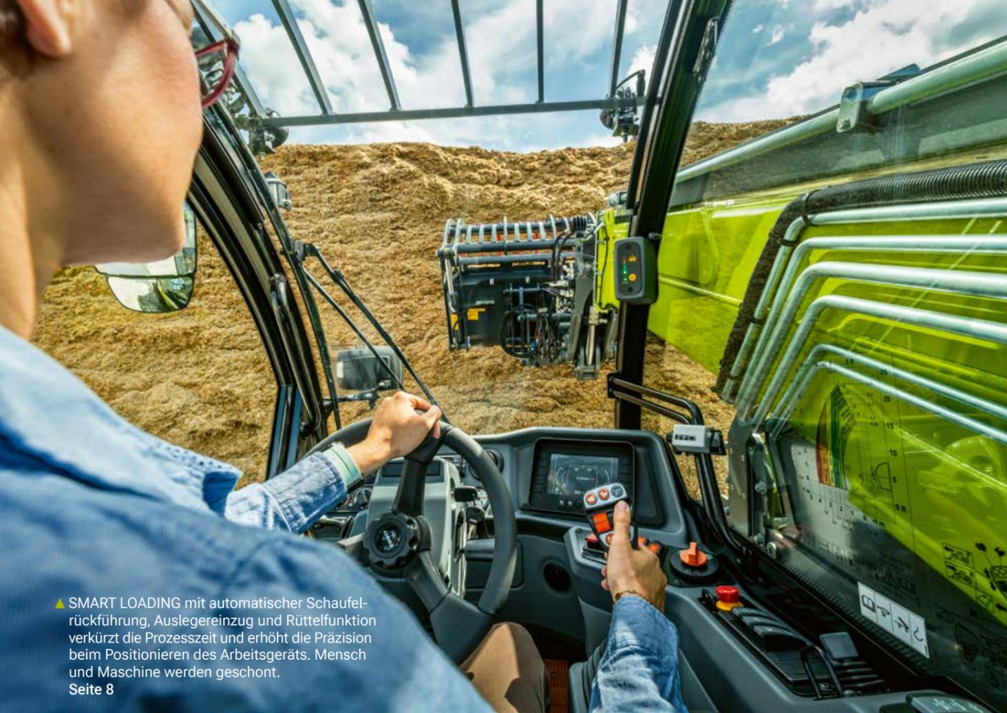
▲ SMART LOADING mit automatischer Schaufelrückführung, Auslegereinzug und Rüttelfunktion verkürzt die Prozesszeit und erhöht die Präzision beim Positionieren des Arbeitsgeräts. Mensch und Maschine werden geschont.
