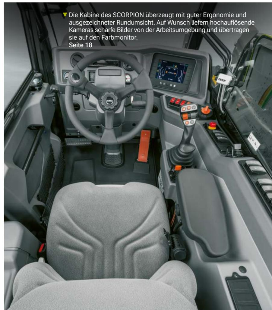
▼ Die Kabine des SCORPION überzeugt mit guter Ergonomie und ausgezeichneter Rundumsicht. Auf Wunsch liefern hochauflösende Kameras scharfe Bilder von der Arbeitsumgebung und übertragen sie auf den Farbmonitor.
