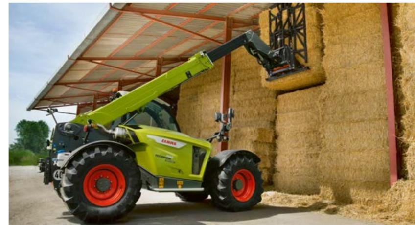
◀ Mit der Feinstuerung für die Arbeitshydraulik stellen Sie Stapelgüter auch in großer Höhe präzise ab und arbeiten feinfühlig mit Gefahrgütern oder schweren Lasten. Sie betätigen nur den Kippschalter, schon reduziert sich die Geschwindigkeit der Arbeitshydraulik automatisch um die Hälfte.
