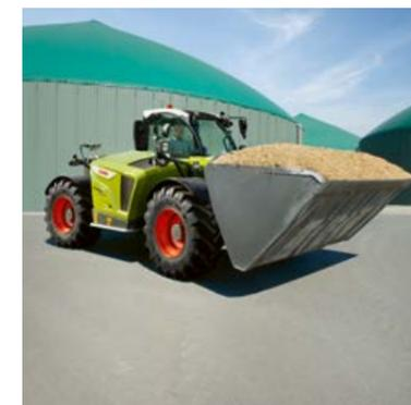
Stufenloser Fahrkomfort von 0 bis 40 km/h. So werden lange Einsätze zum entspannten Vergnügen. Dank hydrostatischem Fahrtrieb erledigen Sie Ihre Arbeit schnell und effizient. Vorwärts und rückwärts sind gleiche Geschwindigkeiten möglich. Unabhängig von der Motordrehzahl können Sie die Fahrgeschwindigkeit einfach und bequem durch leichten Druck auf das Inch-Pedal anpassen.
