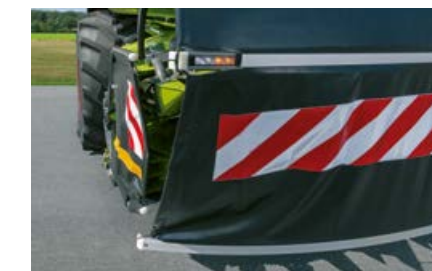
Боковые и передние щитки с предупреждающими наклейками хорошо видны. Светодиодное освещение является полностью встроенным.
