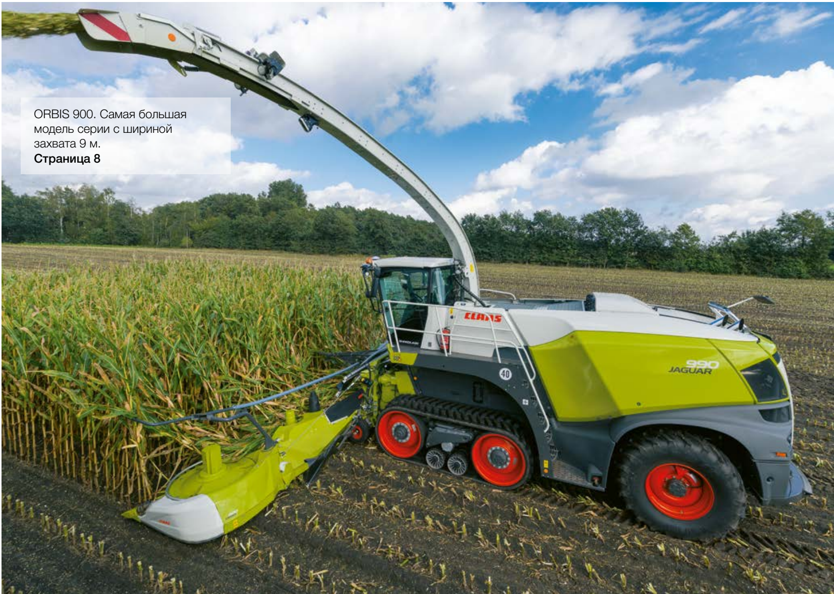
Автоматическая защита от повреждений при транспортировке. Транспортная ширина 3 м для всех моделей ORBIS. Страница 16
