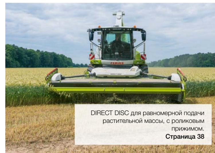
DIRECT DISC для равномерной подачи растительной массы, с роликовым прижимом.
