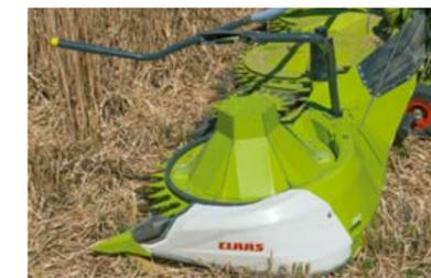
Большой конус для полеглой кукурузы оптимизирует поток растительной массы и предотвращает задержку растительной массы на подающем диске.
