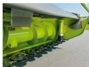
DIRECT DISC 600/500 с подающим шнеком большого размера.
