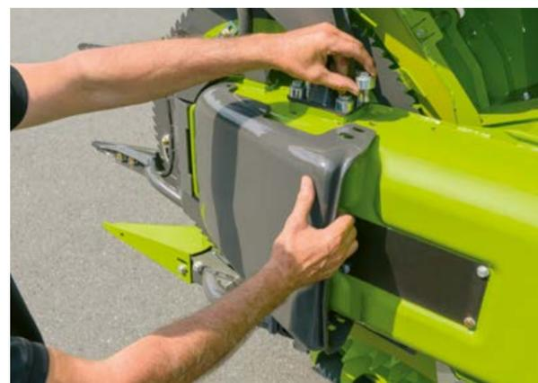
Скользящие башмаки с двухступенчатой регулировкой по высоте.
