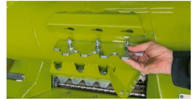
Смена планок на подающих лопастях реализована очень удобно. Для бесперебойного потока материала при небольших объемах урожая рекомендуется использовать более высокие подающие планки с зубьями.
