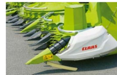
Делитель для полеглой кукурузы с гидравлическим приводом.
