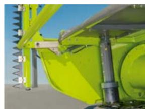
Pettine compensatore regolabile, a richiesta anche idraulicamente.
