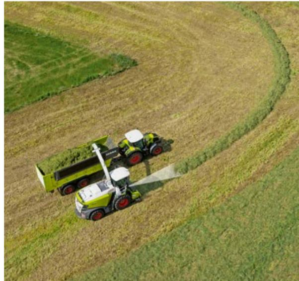
Il CLAAS CAM PILOT rileva le andane in forma tridimensionale e attua automaticamente i corrispondenti impulsi di sterzo. Il comando è attivabile, come di consueto tramite la leva di avanzamento, ed è disattivabile con un movimento di rotazione del volante.
