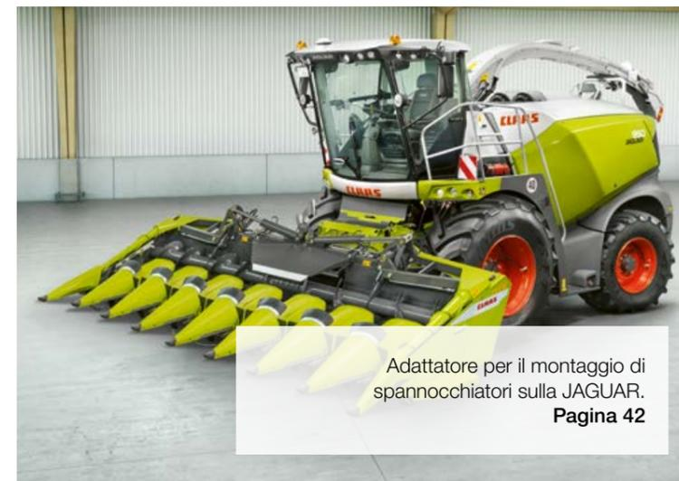
Adattatore per il montaggio di spanocchiatori sulla JAGUAR.
