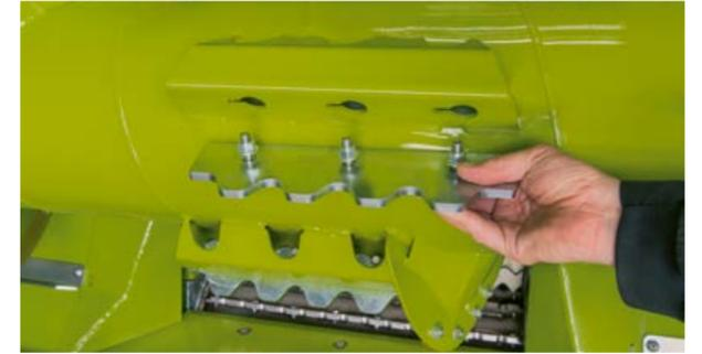
La sostituzione delle spranghe sulle pale di trasporto è una pratica soluzione. Per un flusso di prodotto regolare con volumi di raccolta ridotti si consigliano spranghe alimentatrici rialzate e dentate.
