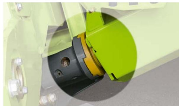
Trasmissione della potenza tramite attacco rapido.
