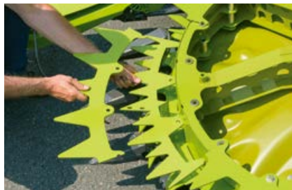
Struttura modulare.
