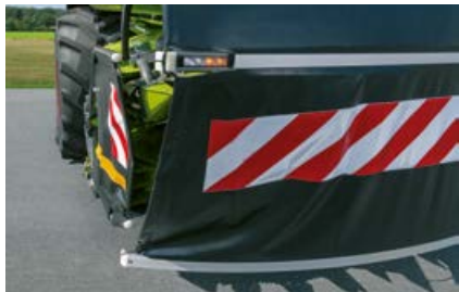
Le protezioni laterali e la protezione anteriore sono ben visibili grazie alle applicazioni adesive di segnalazione. L'illuminazione a LED è totalmente integrata.
