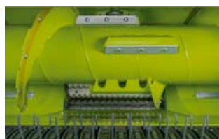
Accessori: listelli copertura battitore lisci e rulli di appoggio di grandi dimensioni
