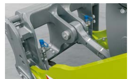
Pełne przygotowanie dla dwóch dodatkowych przyłączy hydraulicznych.
