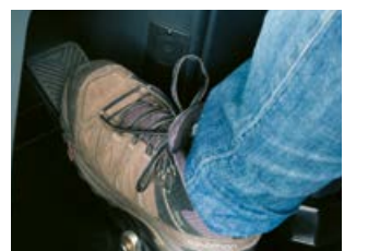
Pedał hamulca z funkcją sprzęgła naciśnięciem palca
