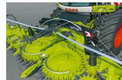
A védőponyvá az adapteren marad, elhelyezkedése kompakt, nem zavarja az ORBIS-ra történő rálátást betakarítás közben
