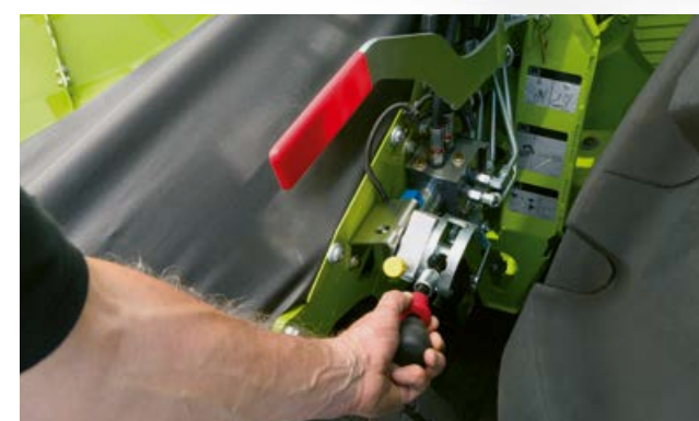
Terelődobok három fokozatú fordulatszám-beállítása az optimális terményáramlás érdekében
