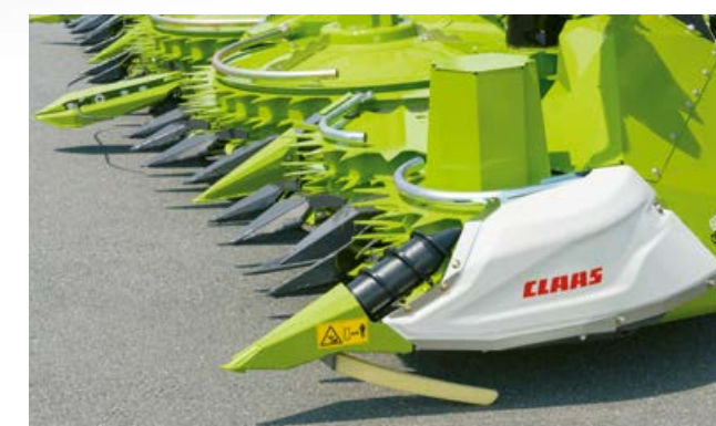
Szükség esetén hidraulikus hajtású csigák fekvő kukoricához
