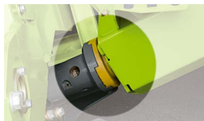
Erőátvitel gyorscsatlakozón keresztül
