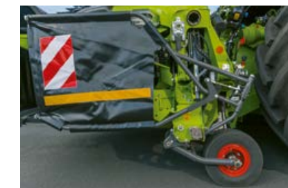
Az integrált járószerkezet lengéscsillapítással magas vezetési kényelem biztosít
