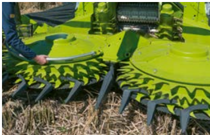
A csőfogók leszerelése növeli a termésáramlást
