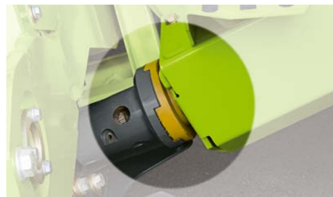
Erőátvitel gyorscsatlakozón keresztül
