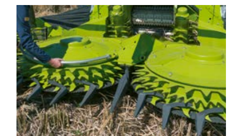
A csőfogók leszerelése növeli a termésáramlást
