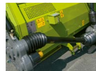
Erős hajtáslánc háromfokozatú sebességváltóval
