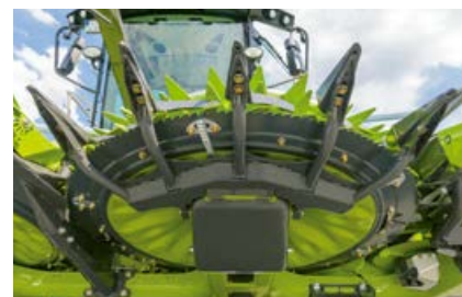
Mocne palce prowadzące i zgarniacze pod tarczą tnącą umożliwiają czystą pracę.
