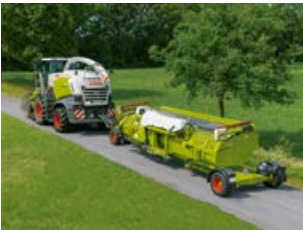
Wózek transportowy z ułożonym DIRECT DISC.
