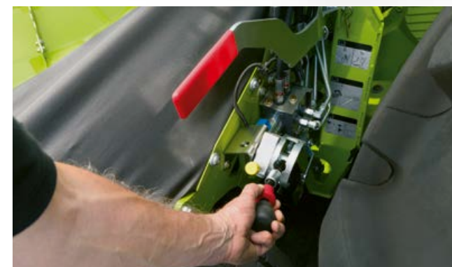
Trójstopniowe dopasowanie liczby obrotów bębnow zasilających dla optymalnego przepływu materiału.
