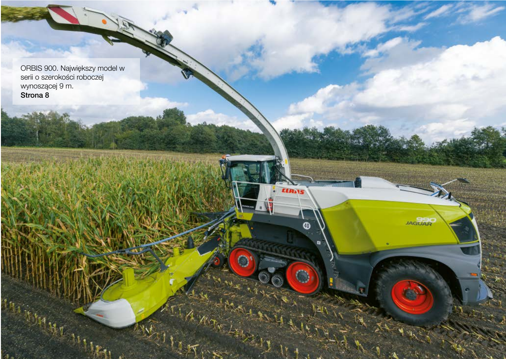
Szybkie składanie i rozkładanie. Gotowość do pracy na polu lub jazdy po drodze w ciągu maks. 30 sekund bez konieczności wysiadania. Strona 16
