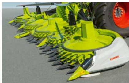
Bardzo płaska konstrukcja zapewnia niską wysokość ścienniska.
