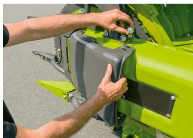
Płozy ślizgowe z dwustopniową regulacją wysokości.
