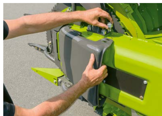
Płozы ślizgowe z dwustopniową regulacją wysokości.
