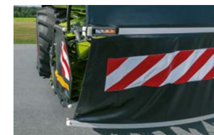
Naklejki ostrzegawcze zapewniają dobrą widoczność osłon bocznych i osłony przedniej. Oświetlenie LED jest w pełni zintegrowane.
