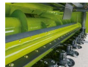
DIRECT DISC 600 P/500 P z regulacją wysokości walca łopatkowego, opcjonalnie również hydrauliczną.
