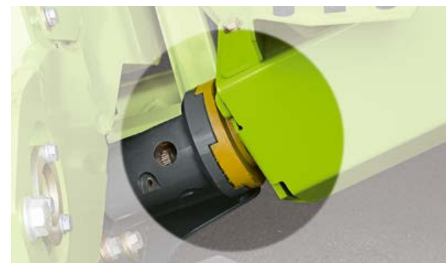
Przeniesienie siły przez szybkołącz.
