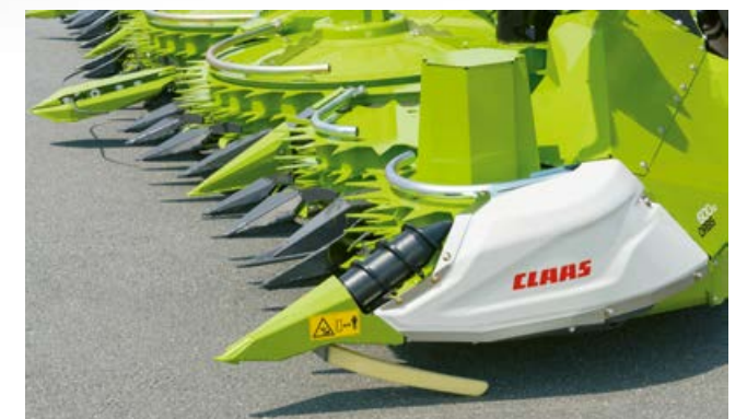
W razie potrzeby napęd ślimaków do wyległej kukurydzy jest zasilany hydraulicznie.
