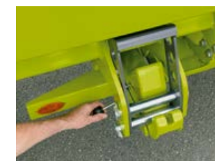
Po zaryglowaniu bezpieczna jazda po drodze z prędkością do 40 km/h.
