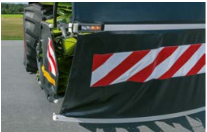
Protecția laterală și frontală sunt vizibile în mod clar datorită autocolantelor de avertizare. Iluminarea LED este complet integrată.
