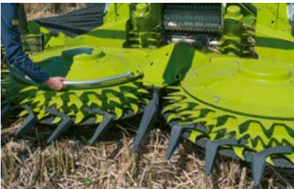
Demontarea elementelor de reținere a știuleților sporește fluxul de material recoltat.
