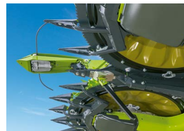
AUTO CONTOUR tastebøjle i midten, fås til ORBIS 900.
