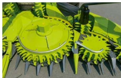
Sikker transport af planterne i materialestrømskanalerne.
