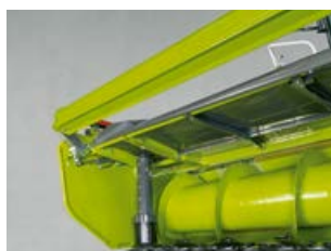
Repartidor de rodillos para una alimentación muy homogénea del material de cosecha.
