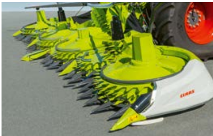
Construcción muy plana para rastrojos bajos.
