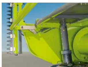
Sujetadores ajustables, opcionalmente también de forma hidráulica.
