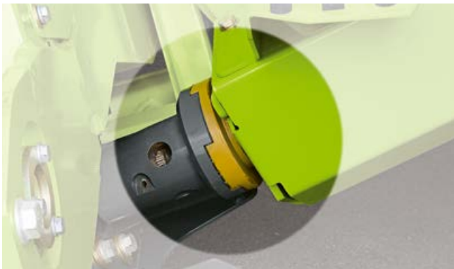
Traspaso de fuerza con acople rápido.
