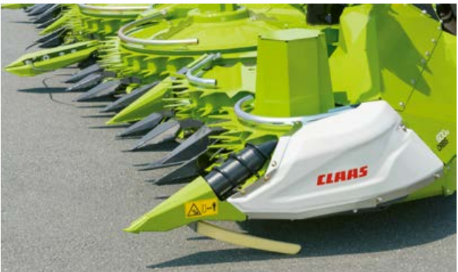
En caso necesario, el accionamiento de los sinfines de maíz tumbado tiene lugar de forma hidráulica.
