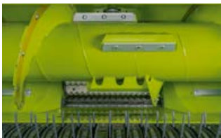
Accesorios: Ángulos de cobertura lisos del cilindro de trilla y gran rodillo de apoyo
