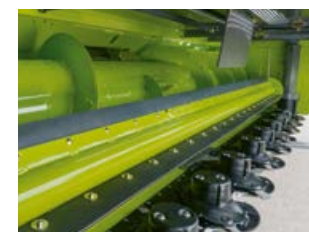
DIRECT DISC 600 P / 500 P con rodillo de palas ajustable, opcionalmente hidráulico.
