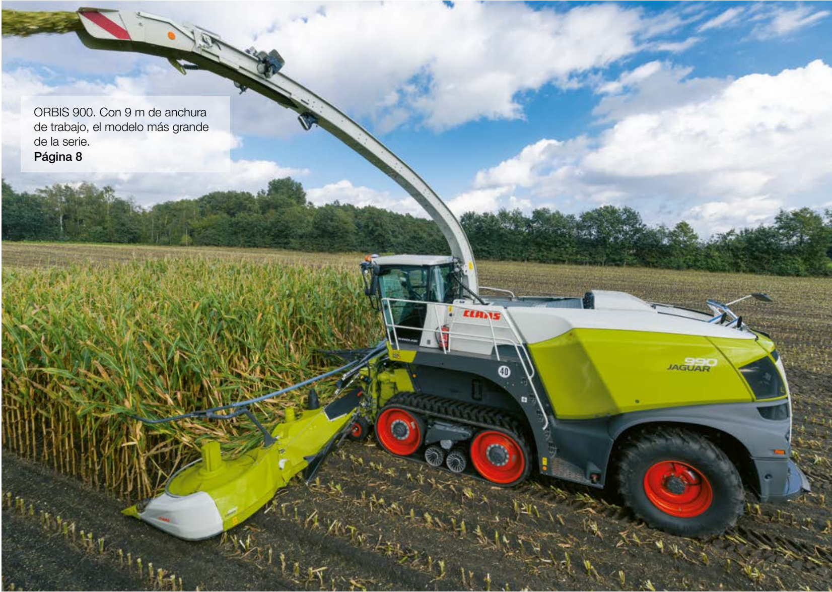
Protección automática para el transporte. Anchura de transporte de 3 m para todos los modelos ORBIS. Página 16
