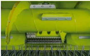
Accesorios: Ángulos de cobertura lisos del cilindro de trilla y gran rodillo de apoyo
