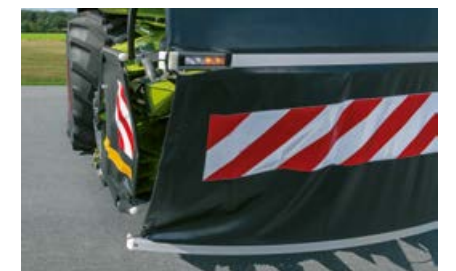
La protección delantera y las laterales se ven perfectamente con los adhesivos de advertencia. La iluminación LED está totalmente integrada
