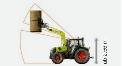
Hochdachkabine mit Glasdachluke: Durchfahrts Höhe ab 2,66 m.
