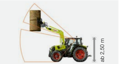
Niedrigdachkabine mit Glasdachluke: Durchfahrts Höhe ab 2,50 m.
