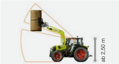
Niedrigdachkabine mit Glasdachlücke: Durchfahrtshöhe ab 2,50 m.
