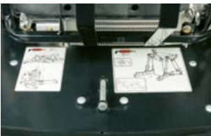
Unter der Motorhaube befindet sich ein Schmierplan, der die Wartung vereinfacht.
