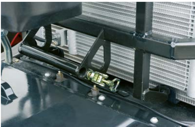
Schmierstellen der Vorderachse vor dem Kühlerpaket für eine optimale Erreichbarkeit.
