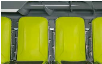
Die Pflückplatten lassen sich hydraulisch verstellen.
