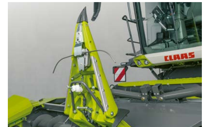
Zwei Tastbügel tasten je eine Maisreihe ab.
