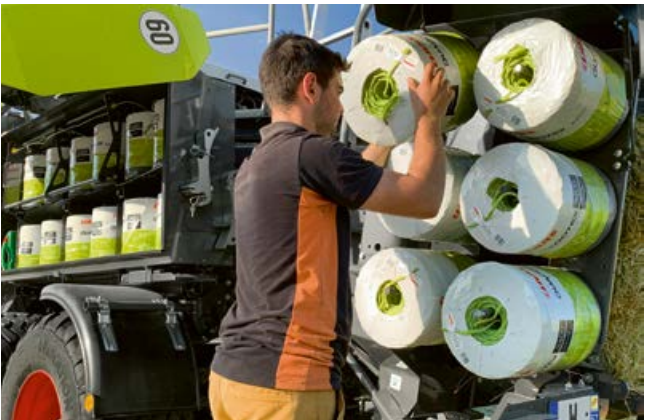
Optional: Platz für 12 zusätzliche Garnrollen. Das reicht je nach Rollengröße für 350-400 gepresste Ballen.
