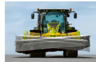
Adaptação transversal em relação ao sentido de marcha por meio de uma suspensão com oscilação livre.
