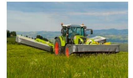
Devido à suspensão compacta no sistema mecânico dianteiro, a gadanheira possui uma grande distância livre em relação ao solo ao nível da cabeceira.
