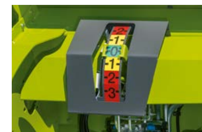
Knivbjælakens aktuelle position er let at se fra kabinen.
