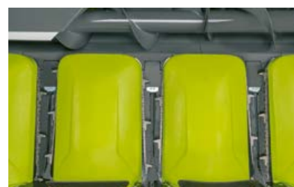
Plukkepladerne kan reguleres hydraulisk.
