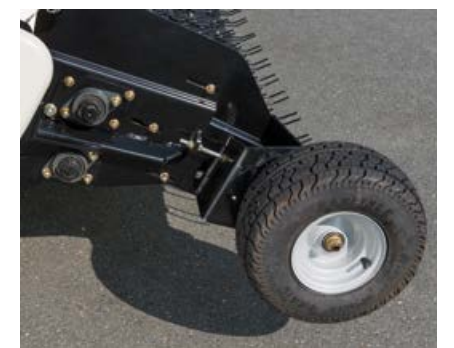
Arbejdsdybden kan indstilles med tastehjulene.
