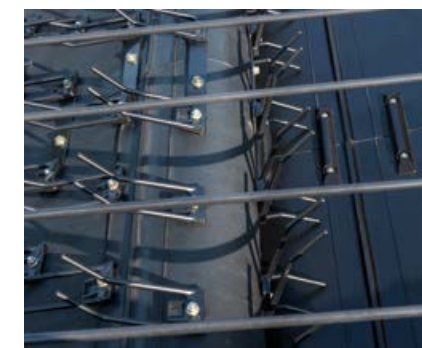
Piikit nostavat materiaalin nopeasti ja siirtävät sen eteenpäin.
