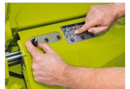
Pysäköinti- ja puhdistusasennon säätö suoraan leikkuupöydässä
