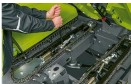
Kuljetinketjut voidaan kiristää helposti.
