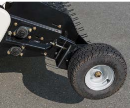
La profundidad de trabajo se puede graduar con las ruedas palpadoras
