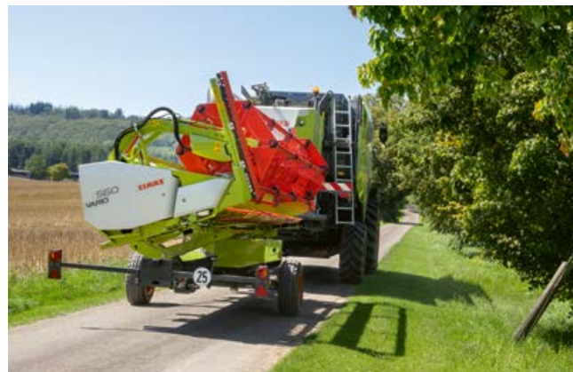
También con cuchillas separadoras de colza montadas, los mecanismos de corte VARIO tienen unas medidas compactas en carretera.
