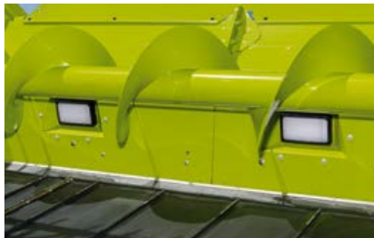
Potentes focos de trabajo iluminan de forma perfecta el mecanismo de corte y la cuba.
