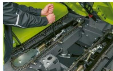
Las cadenas transportadoras puede retensarlas fácilmente.
