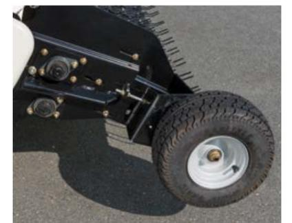
La profundidad de trabajo se puede graduar con las ruedas palpadoras
