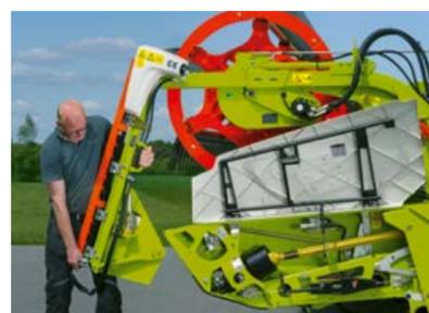
Plug and Play para la cosecha de colza. El montaje de las cuchillas separadoras de colza accionadas hidráulicamente se realiza sin herramientas y en pocos minutos. Cuando las cuchillas separadoras de colza están montadas, son activados automáticamente los sinfines de alimentación. Así el mecanismo de corte está preparado para la cosecha de colza.
