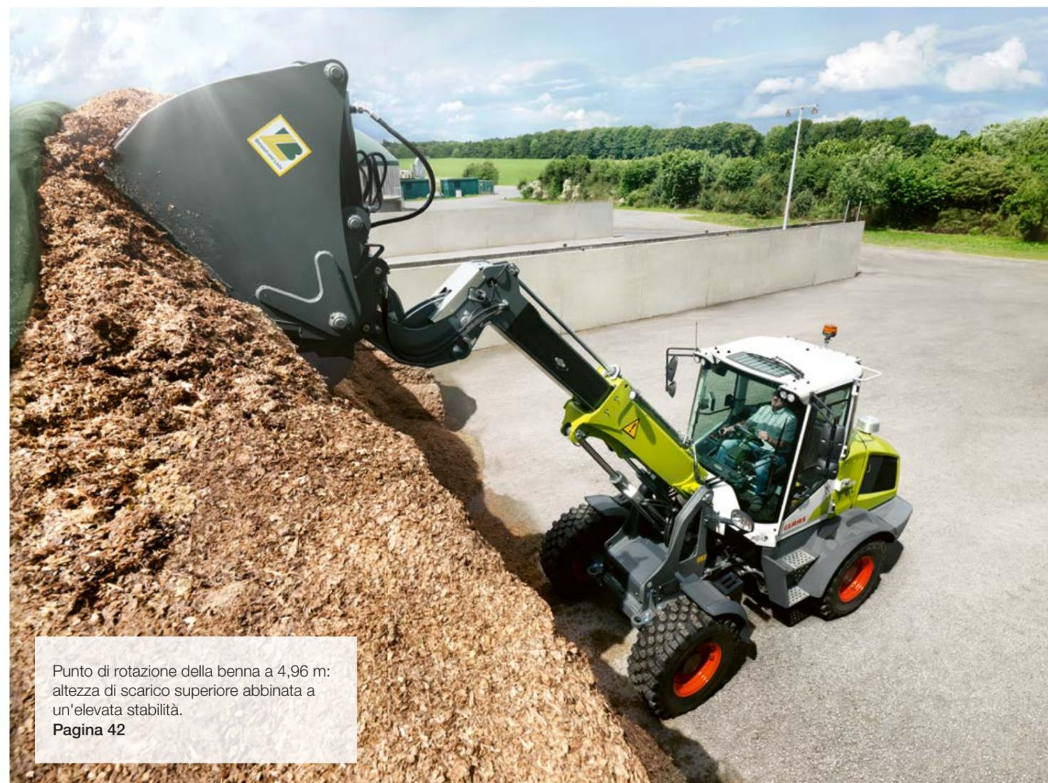
Punto di rotazione della benna a 4,96 m: altezza di scarico superiore abbinata a un'elevata stabilità.
