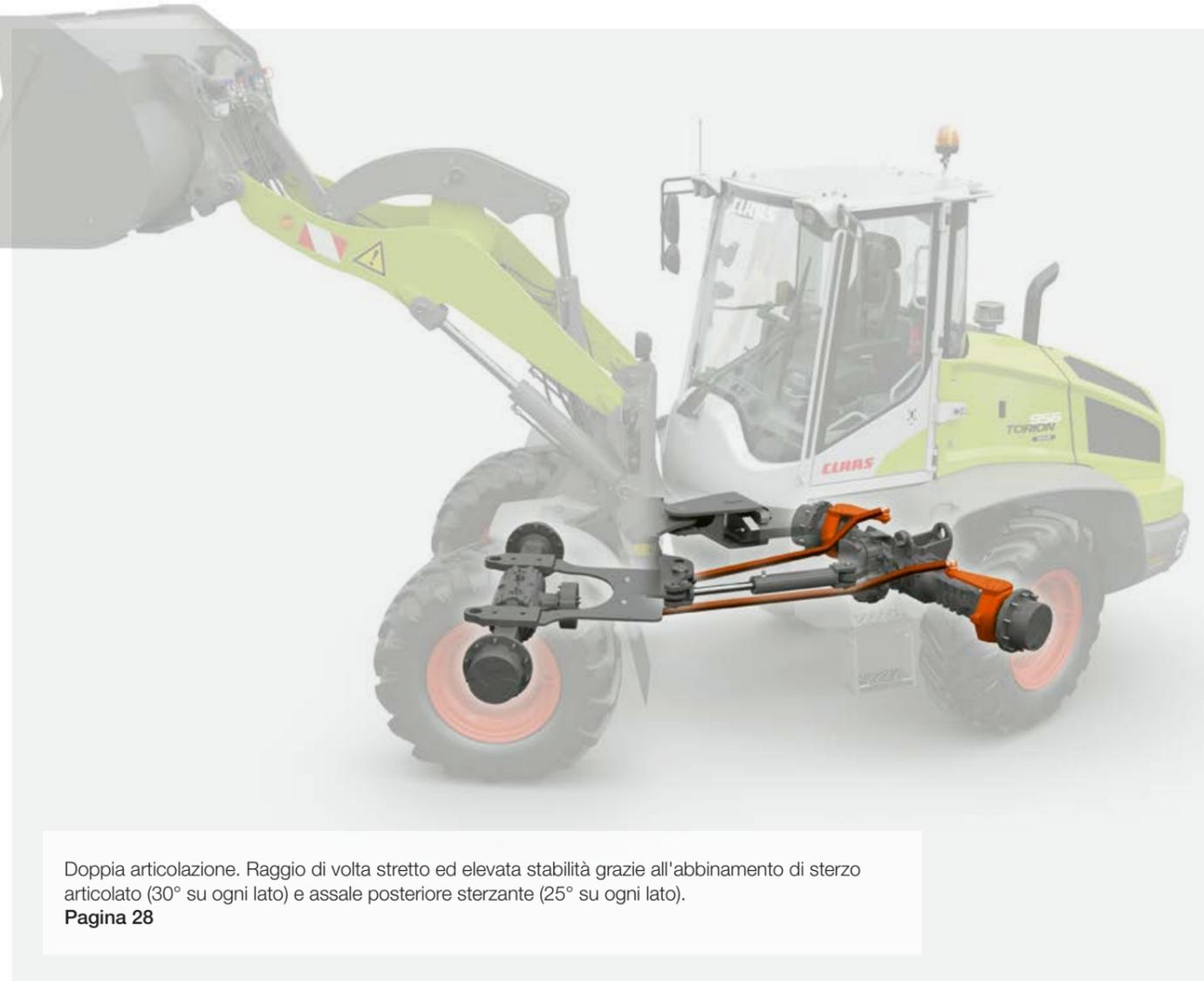
Doppia articolazione. Raggio di volta stretto ed elevata stabilità grazie all'abbinamento di sterzo articolato (30° su ogni lato) e assale posteriore sterzante (25° su ogni lato).
