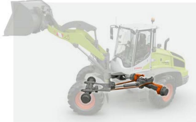
Proprio per questo è stato sviluppato il telaio della TORION SINUS. La macchina non sterza soltanto a livello del giunto articolato oscillante centrale, ma anche dell'assale posteriore. Due barre di sterzo collegano la parte anteriore ai fuselli posteriori. Non appena si ruota il volante per cambiare direzione, l'assale gira in modo sincronizzato.
