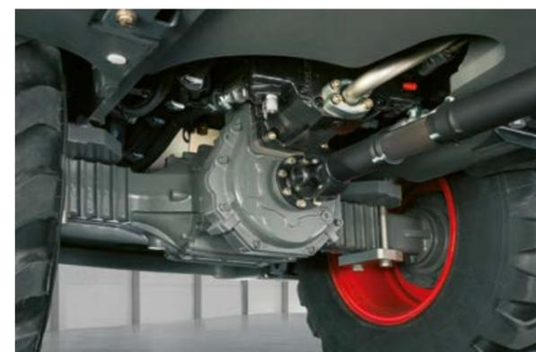
Trasmissione idrostatica con azione frenante autobloccante.
