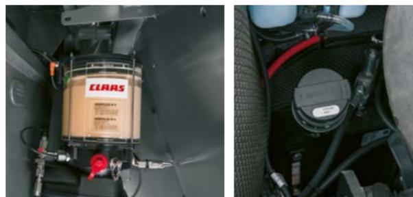
I bocchettoni per l'immissione dell'olio idraulico sono collocati in una zona pulita sotto il cofano motore. Il livello dell'olio può essere controllato direttamente attraverso un vetro spia ben visibile.
