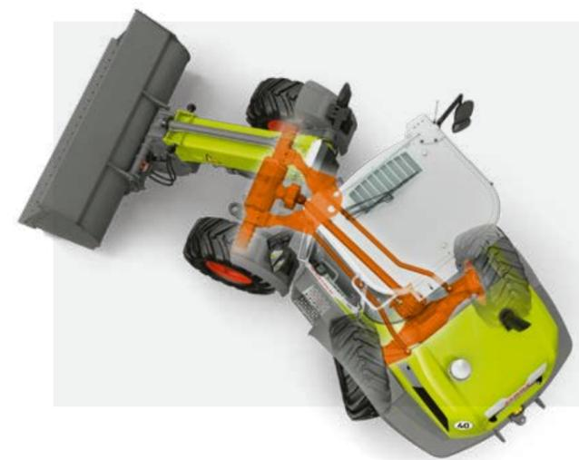
L'elevato angolo di oscillazione assicura un'ottima stabilità anche quando la pala cariatrica gira di lato su terreni irregolari. Nel giunto articolato oscillante la TORION 738 T SINUS oscilla di 8° su ogni lato.
