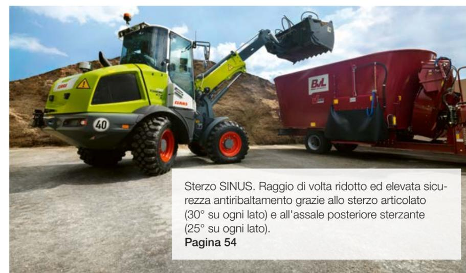
Sterzo SINUS. Raggio di volta ridotto ed elevata sicurezza antibaltamento grazie allo sterzo articolato (30° su ogni lato) e all'assale posteriore sterzante (25° su ogni lato).
