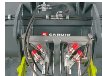
Wolny spływ z przodu i dodatkowy przewód wolnego spływu z przyłączem do nośnika narzędzi (644 / 537)
