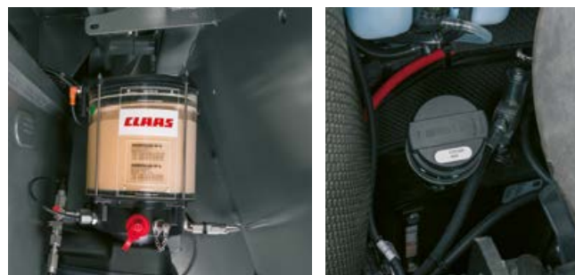
Króciec wlewu oleju hydraulicznego jest schowany w czystym obszarze pod maską silnika. Poziom oleju można odczytać bezpośrednio przez dobrze widoczny wzniesienie.
