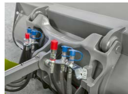
Wszystkie przyłącza są umiejscowione w łatwo dostępnym sposób na nośniku narzędzi i odpowiednio zabezpieczone. (956)
