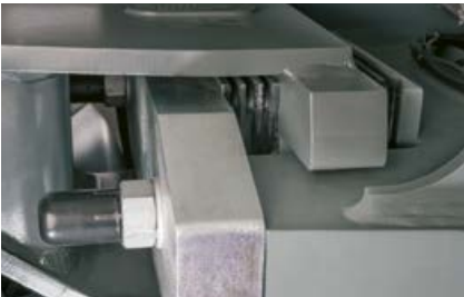
Gumowe amortyzatory w przegubie wahlowym podnoszą komfort pracy.
