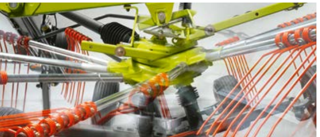
Карданная подвеска роторов: роторы копируют рельеф почвы независимо от трактора.
