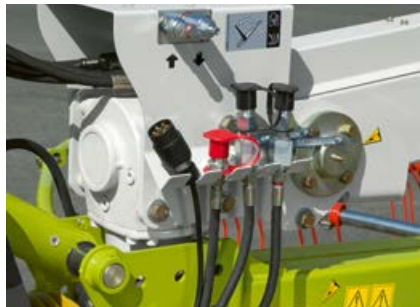
Серийная гидравлическая система последовательного управления для настройки времени смещения между передним и задним ротором при поднятии и опускании.
