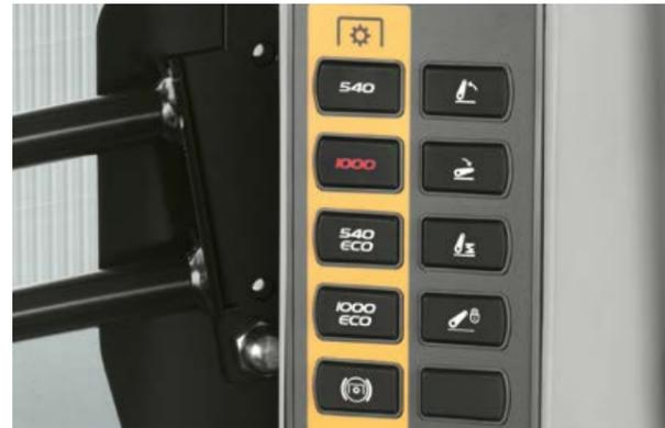
Toma de fuerza con un régimen adaptado de revoluciones del motor.
