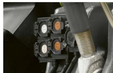
En combinación con el elevador delantero están disponibles hasta cuatro conexiones hidráulicas y un retorno libre en la parte delantera. Ideal para una tolva de semillas o una plancha compactadora montada en la parte delantera.
