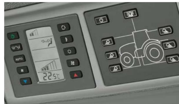
Además del control manual del aire acondicionado, está también disponible una instalación de aire acondicionado totalmente automática que reparte la corriente de aire cómodamente por la cabina.
