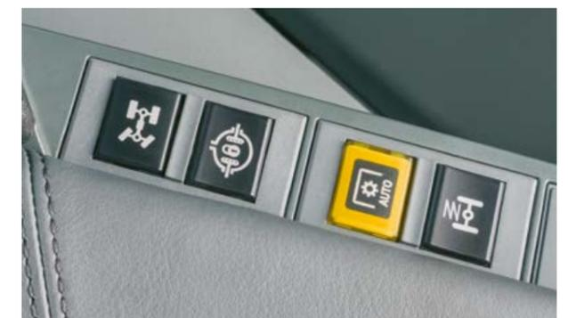
Activación de la suspensión del eje delantero.
