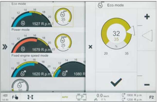
Impostazione del carico motore per i valori «Eco» e «Power» e della memoria regime motore
