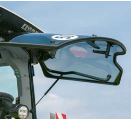
Den tonede bagrude (ekstraudstyr) giver et behageligt klima i kabinen uden blænding i den lave aftensol.
