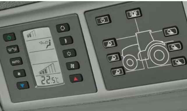
Ud over den manuelle klimastyring fås et automatisk klimaanlæg, som fordeler luftstrømmen behageligt i kabinen.
