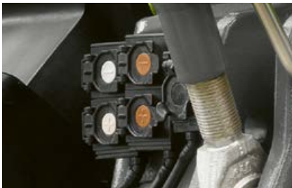
Sammen med frontliften kan man få op til fire hydraulikudtag og et frit returløb foran. Det er perfekt til en såsædstank eller et frontmonteret dozerblad.
