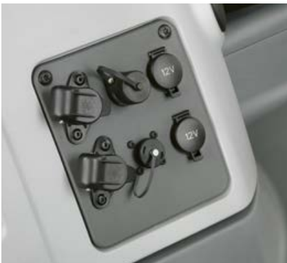
Under den højre konsol er alle tilslutninger til strømforsyningen og ISOBUS til yderligere terminaler anbragt.
