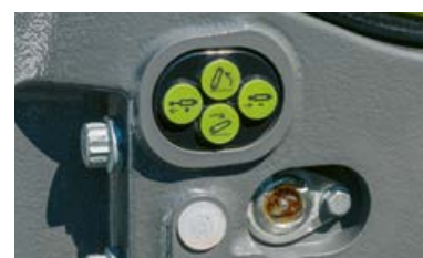
Obsługa przedniego podnośnika i zaworu hydraulicznego z zewnątrz w wersji CEBIS.
