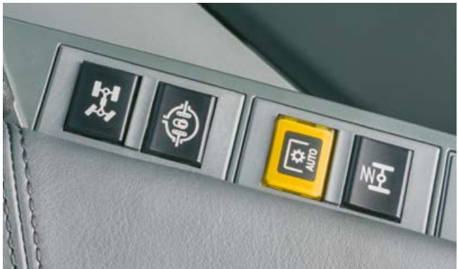
Aktywacja amortyzacji przedniej osi.
