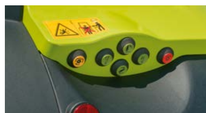
Zewnętrzne elementy obsługi tylnego podnośnika, WOM i dowolnie wybranego zaworu hydraulicznego (tylko CEBIS).
