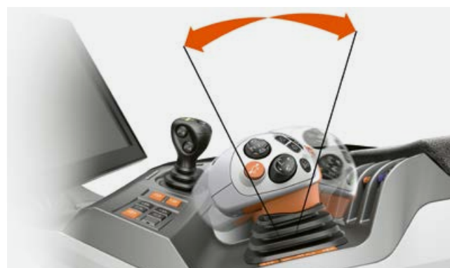
Obsługa progresywna dzięki technologii bezstopniowej przekładni CMATIC.
