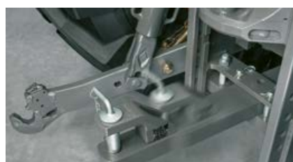
Zaczepty polowe są dostępne w różnych pozycjach. Możliwa jest pozycja wysunięta co poprawia zwrotność z narzędziem.
