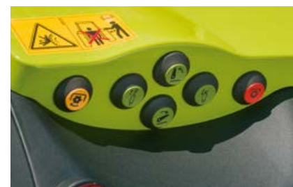
Zewnętrzna obsługa tylnego WOM na obu błotnikach.
