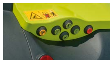
Comenzi externe pentru tiranții spate, priza de putere și o supapă hidrolică selectabilă (doar pentru varianta CEBIS)
