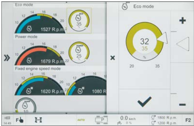
Suprasarcina motorului pentru modurile „Eco” și „Power” și turația motorului memorată
