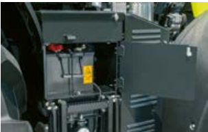
Bateria este amplasată deasupra scării de acces din partea dreaptă, fiind ușor de accesat.
