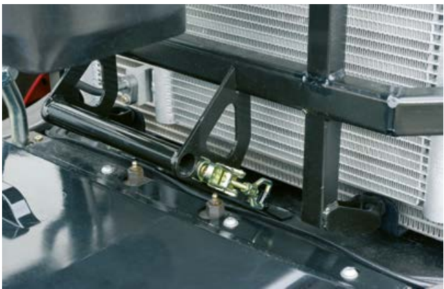
Pentru un acces optim, punctele de lubrifiere de pe puntea față sunt situate în fața ansamblului radiatorului.
