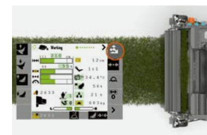
Den hydrauliske PFS-indføring indstilles nemt fra traktorsædet.
