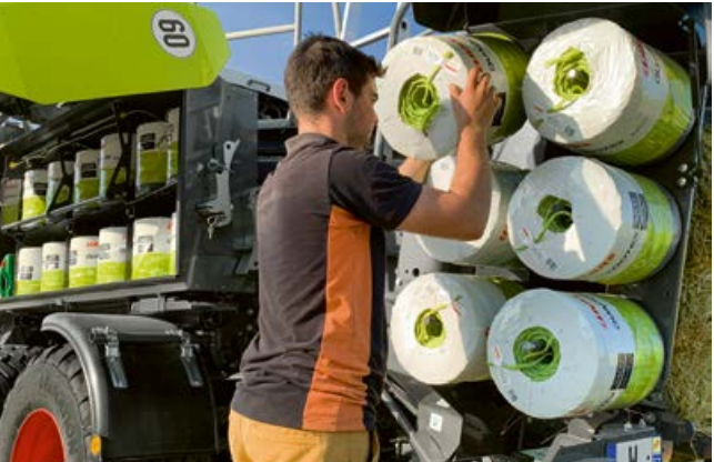
Ekstraudstyr: Plads til 12 ekstra garnruller. Det rækker til 350-400 pressede baller alt efter rullens størrelse.
