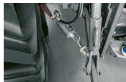
Opcjonalne hydrauliczne stabilizatory boczne poprawiają bezpieczeństwo i ułatwiają pracę.
