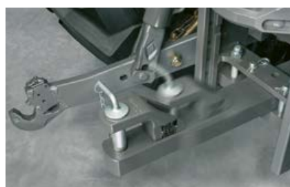
Versiunile de bară de tracțiune oferă mai multe poziții. Poziția extinsă sporește manevrabilitatea.
