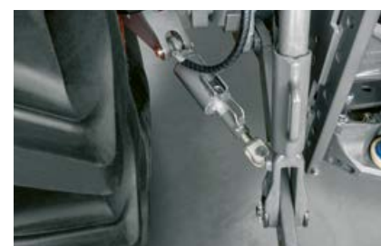
Elementele laterale de stabilizare hidraulice opționale oferă siguranță sporită și facilitează munca.
