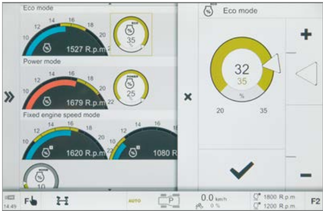
Ajuste del régimen reducido del motor para "Eco" y "Power", así como para la memoria del régimen de revoluciones.
