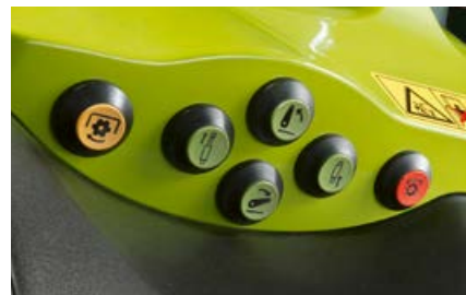
Elementos externos de mando para el elevador trasero, la toma de fuerza y un distribuidor hidráulico a elegir
