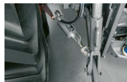
Gli stabilizzatori idraulici laterali, in opzione, offrono una maggiore sicurezza e facilitano il lavoro.
